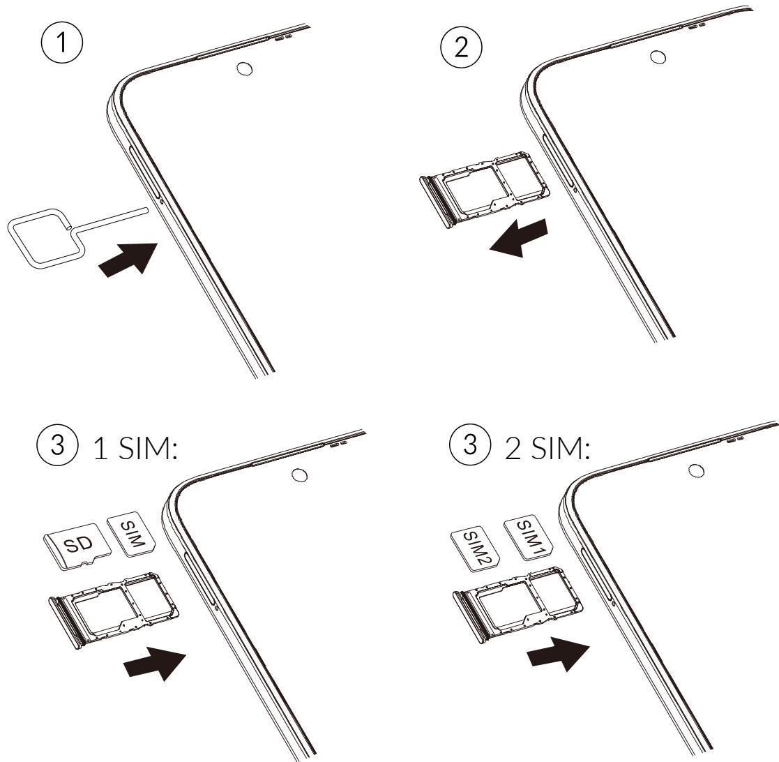
Debe insertar la tarjeta SIM para poder realizar llamadas. No es necesario que apague el teléfono antes de insertar o extraer la tarjeta SIM, ya que este teléfono es compatible con el cambio estando encendido.
