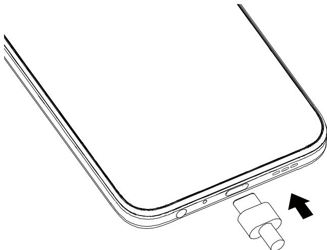
Se recomienda cargar la batería completamente (
